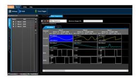
在多序列模式下,可以定义两个独立序列用于控制通道1和通道2(和相应的数字通道),独立控制的双通道就如同两台独立的信号发生器。
