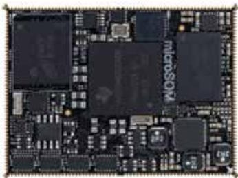
microSOM uS01, TI的Sitara ARM-Cortex-A8基microSOM标准, 满足提高系统性能的要求。
