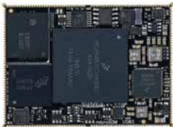
uS03是高创新性、高性能 i.MX 6 Quad/Dual/DualLite/Solo core ARM Cortex-A9 of microSOM家族。uS03 microSOM解决方案特别适用于要求多媒体功能和/或高水平并行计算的应用。
