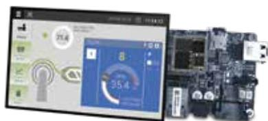
OpenHMI nS01是一款创新的嵌入式智能 IoT 控制器基于 nS01 i.MX 6 UL ARM Cortex-A7 of nanoSOM 模块并且全面集成高分辨率 5英寸 TFT 800x480包含高可靠性投射电容触摸屏传感器。
