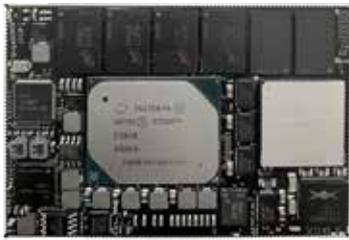
GigaSOM gS01是一款高创新性的、高性能的、非常高效的、又超级紧凑的SOM, 基于Atom E39xx Intel® CPU cores 和 Intel® Cyclone 10 GX FPGA。
