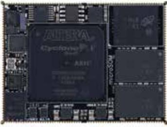
microSOM uS02 Intel Cyclone V SE SoC基新的microSOM标准用于满足提高系统性能的要求。
