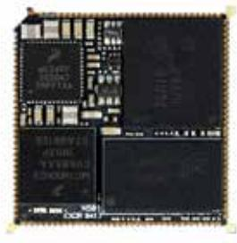
NanoSOM nS01是高创新性，高性能，非常高效，超紧凑和成本效益的，基于i.MX 6 UltraLite CPU ARM Cortex-A7 core的SOM(模块上系统)。
